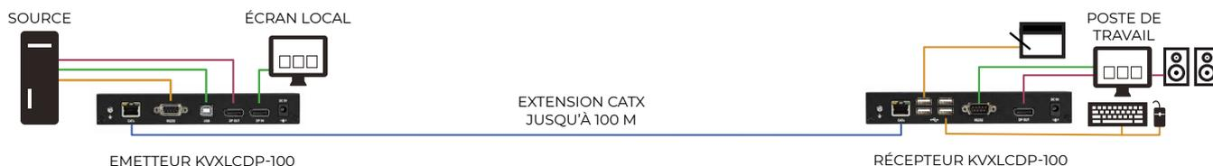
Les extenders KVM transmettent les signaux vidéo, audio et périphériques au-delà de la limite des 5 mètres imposée par le câble en connexion directe.
